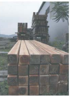
◀「自然乾燥」は、とても手間隙が掛かる昔ながらの乾燥方法です。時間や手間を掛けて少しずつ木材を乾燥させる事が出来ます。それなので、木の繊維を死滅させる事無く製品にすることができます。 自然乾燥を行っている木材
