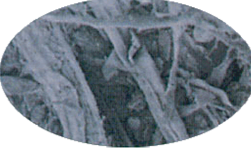
セルロースファイバー(顕微鏡にて) 1本1本の繊維の中にも小さな空気胞がありこれが高い「断熱性」を生み出します。
